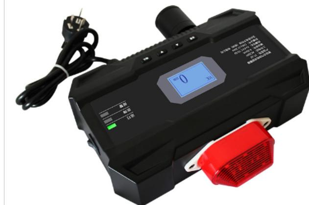
具体指标如下:若使用气体检测仪时,被测对象的可燃气体浓度≤下限20%(体积比、下同);若使用其他化学分析手段时,当被测气体或蒸气的下限≥10%时,其浓度应小于1%;当下限小于10%、≥4%时,其浓度应小于0.5%;当下限小于4%、≥1%时,其浓度应小于0.2%。若有两种以上的混合可燃气体,应以下限低者为准1ppm=1/1,000,000密闭空间,如果将1立方米看作一个密闭空间,则1立方厘米就是1ppm ppm是极微小的体积单位,一般用在可燃气微小泄漏及有毒气体泄漏检测★%VOL是高浓度体积单位,是指被测气体体积与空气体积的百分比,通常用来测定可燃气(天然气,液化石油气,沼气)的体积浓度。根据两者定义1ppm=1/1,000,000VOL1%VOL=10000pm上海苯气体检测仪如果有一氧化碳、硫化氢和其他有毒气体,有必要选择特定的气体检测仪,以确保工人的安全。
